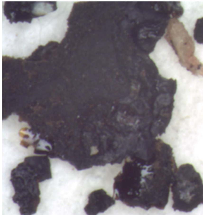
Bild: Provmaterial från A3. Huvudsakligen består provmaterialet av svart, matt färg. Partiellt finner vi dock nedsmält, blankt material, röda korn samt ljusa fragment.
