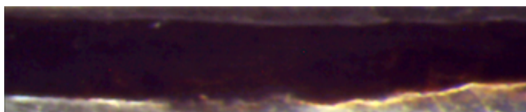
Bild : Prov A6, tvärsnitt av ytskikt från dörrens övre ram fotograferat i ljusmikroskop. Åtminstone tre skikt kan urskiljas.
