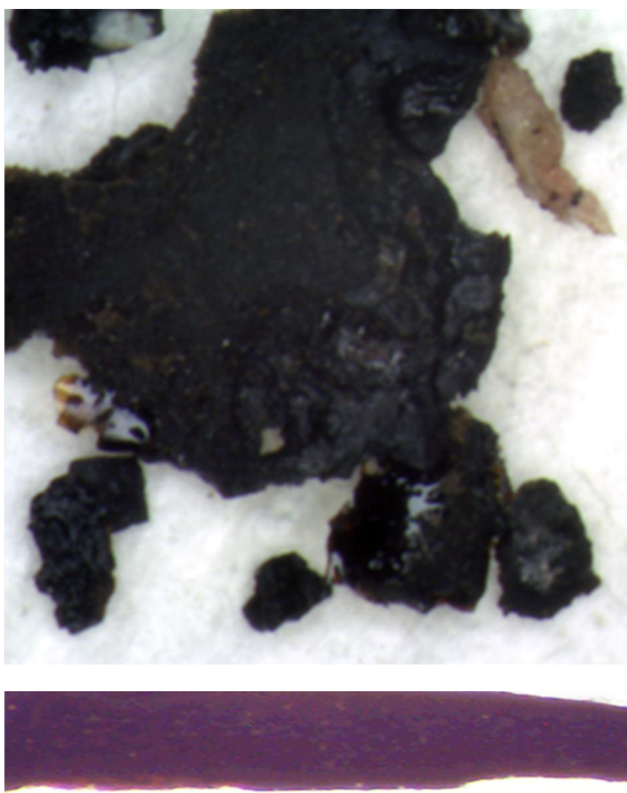
Bild. Provmaterial från punkt A9, översida av svart färg med ljus fragment (upptill till höger). Blankt nedsmält material syns till vänster nedtill. Undre bilden visar ett tvärsnitt av färgflaga från provställe A9 i starkt justerat i ljus och kontrast.
