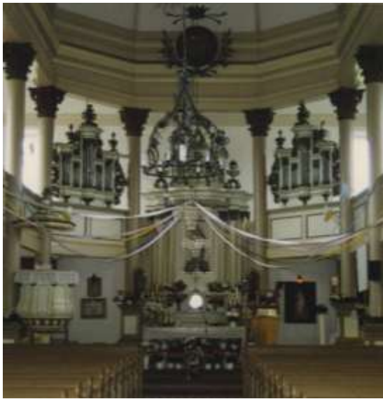
Finkenstein (PL): orgelhus och fasader, varav den vänstra är tom kuliss med träattrapper istället för pipor i fasaden, från verk byggt av Jonas Wistenius läromästare Johan Josua Mosengel, Königsberg 1718 (se Janca & Renkewitz 2008 s 184ff). Foto: Niclas Fredriksson 2004.
