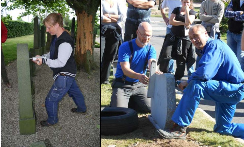
Figur 12. Mätning med tryck-/draginstrumentet. Här med tryck mot en hög resp en låg sten.
