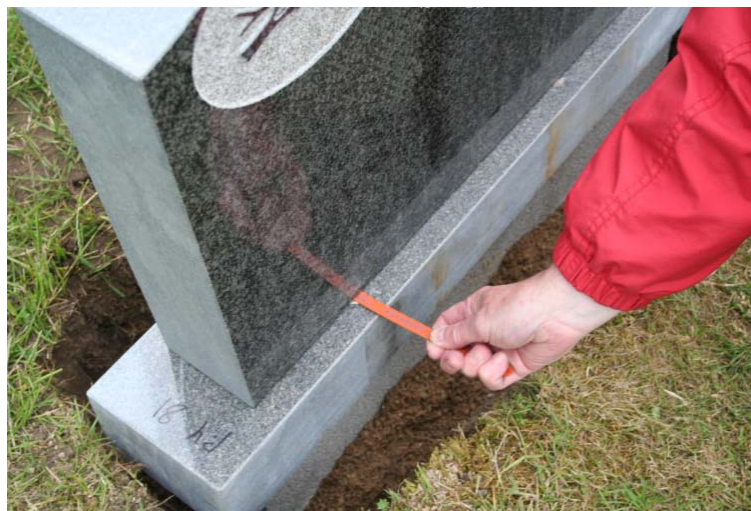
Figur 8. Kontroll av antalet dubbar med bågfilmsblad
