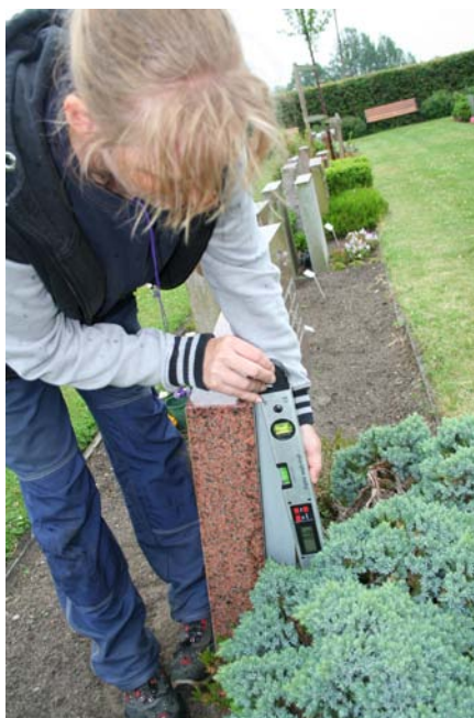
Figur 4. Kontroll av lutning med vinkelindikator.
