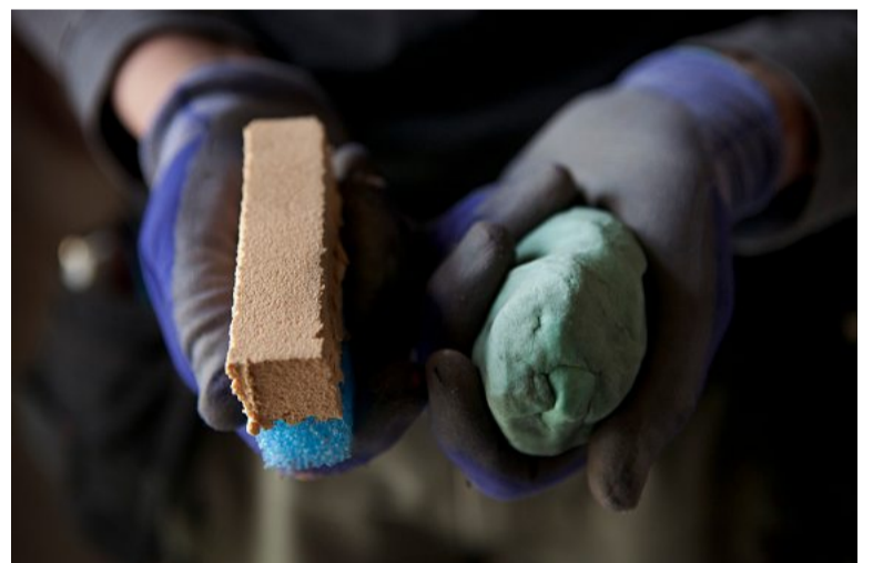
REDSKAP. Här är två olika redskap som används för att rengöra kalkmålningarna från smuts – en svamp och en deg.
