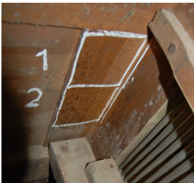
Bild 21: provruta från 2010 på insidan av orgelhusets nordöstra vägg. Provruta 1 som är torrenjord med latexsvamp har angripits av synligt mögel, medan provruta 2 som rengjordes med koncentrerad alkohol ännu är opåverkad.
