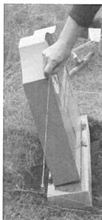
Figur 10. Ett enkelt lod att användas vid kontroll av lutning.
