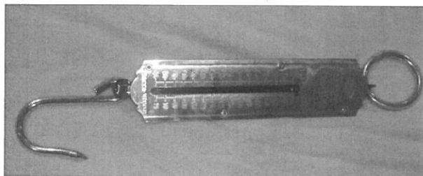
Figur 18. Fjädervåg för max 75 kg (750N)
