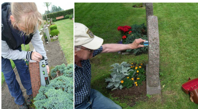
Figur 12. Mätning av lutning med två olika typer av vinkelmätare.
