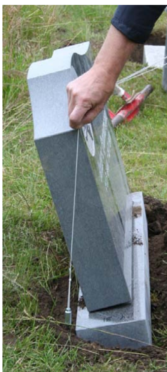
Figur 11. Vinkelmätning med lod.
