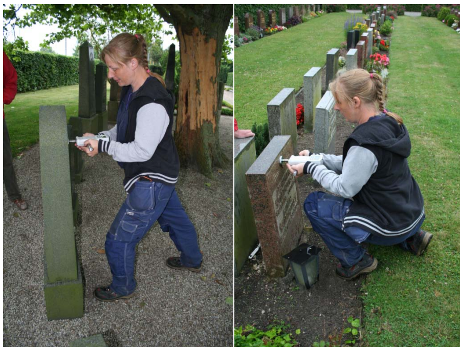
Figur 20 och 21. Mätning med tryck-/draginstrumentet. Här med tryck mot en hög resp en låg sten.
