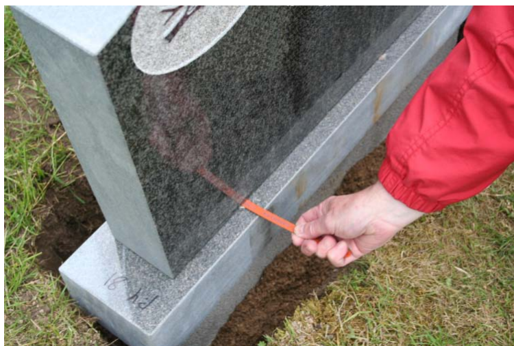
Figur 16. Kontroll av dubbar med bågfilmsblad.
