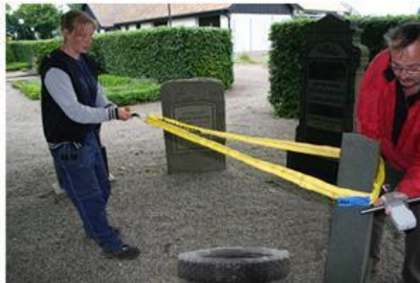
Figur 17. Belastningstest: fjädervåg, lyftstroppslinga och fender, här i form av bildäck.
