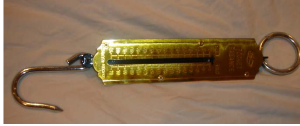
Figur 18. Fjädersvåg för max 75 kg (750N)
