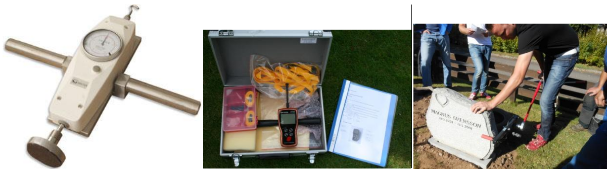
Figur 19. Tre gravstensinstrument. Till vänster FA-500 G från Elastocon AB, Brämhult, i mitten Sauturs instrument komplett i väska och med handledning på svenska, från SweTest, Saltsjö-Boo, Båda med tydlig display, tryckplatta och dragkrok och till höger det av Orax speciellt framtagna instrumentet för prövning av gravstenssäkerhet.
