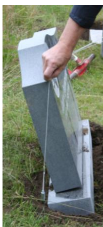
Figur 10. Ett enkelt lod att användas vid kontroll av lutning.
