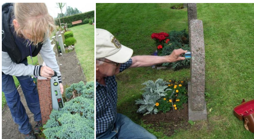
Figur 12. Mätning av lutning med två olika typer av vinkelindikatorer.
