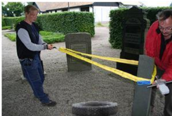
Figur 17. Belastningstest: fjädervåg, lyftstropplinga och fender, här i form av bildäck.
