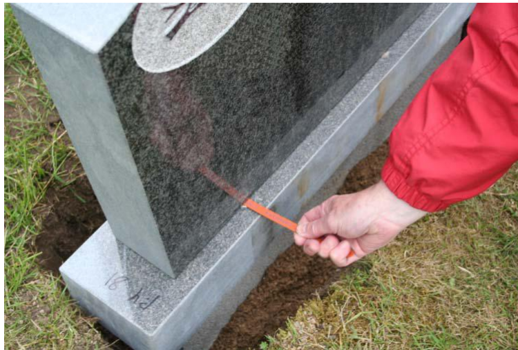
Figur 16. Kontroll av dubbar med bågfilmsblad.
