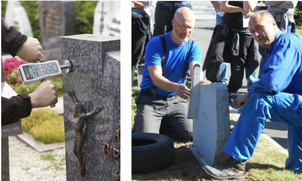
Figur 12. Mätning med tryck-/draginstrumentet. Här med tryck mot en hög respektive en låg gravvård.
