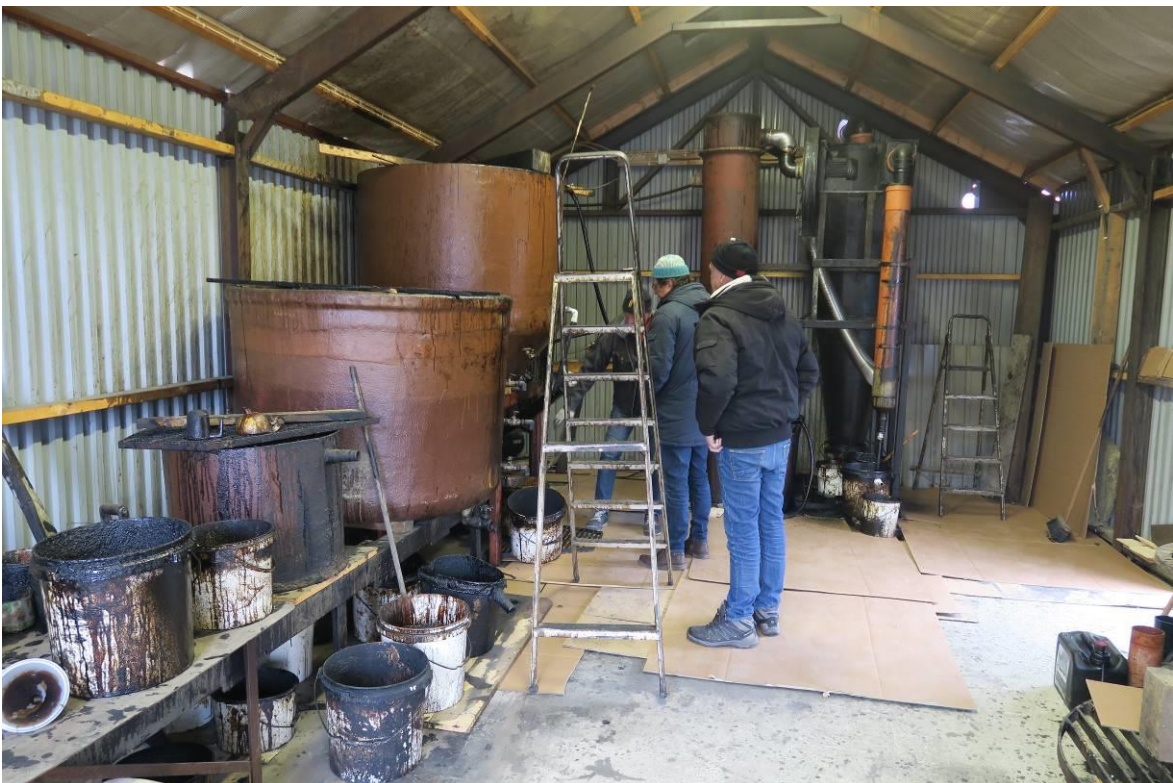
I den intilliggande byggnaden samlas tjäran som utvinns ur rökgaserna i flera steg. Till vänster ses kärl för tillfällig förvaring och uppvärmning av tjära. Den färdiga tjäran värms upp till ca 60-70 grader för att påskynda processen med att separera tjärvattnet.
