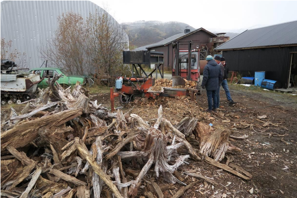
Lager med stubbar och den specialbyggda hydrauliska klyven.
