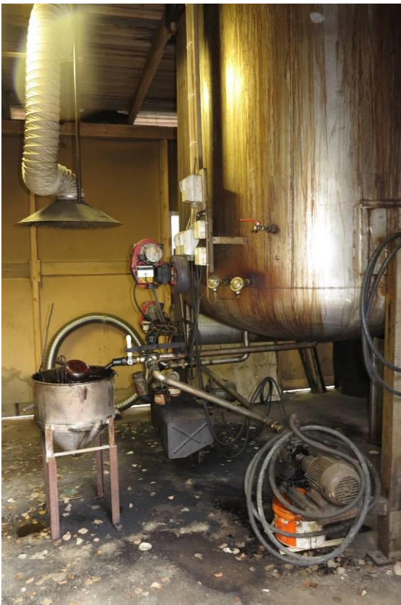
Bod för uppsamling och efterbehandling av tjära. I den rostfria behållaren samlas tjära. För att separera tjärvattnet snabbare värms tjära upp.
