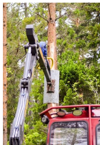
Inledande försök med en plåt monterad på hydralarmen. Foto Monica Syversen.
