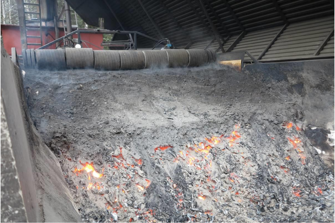
Rullar som med automatik håller efter det isolerande jordskiktet så att glödbädden inte börjar brinna.
