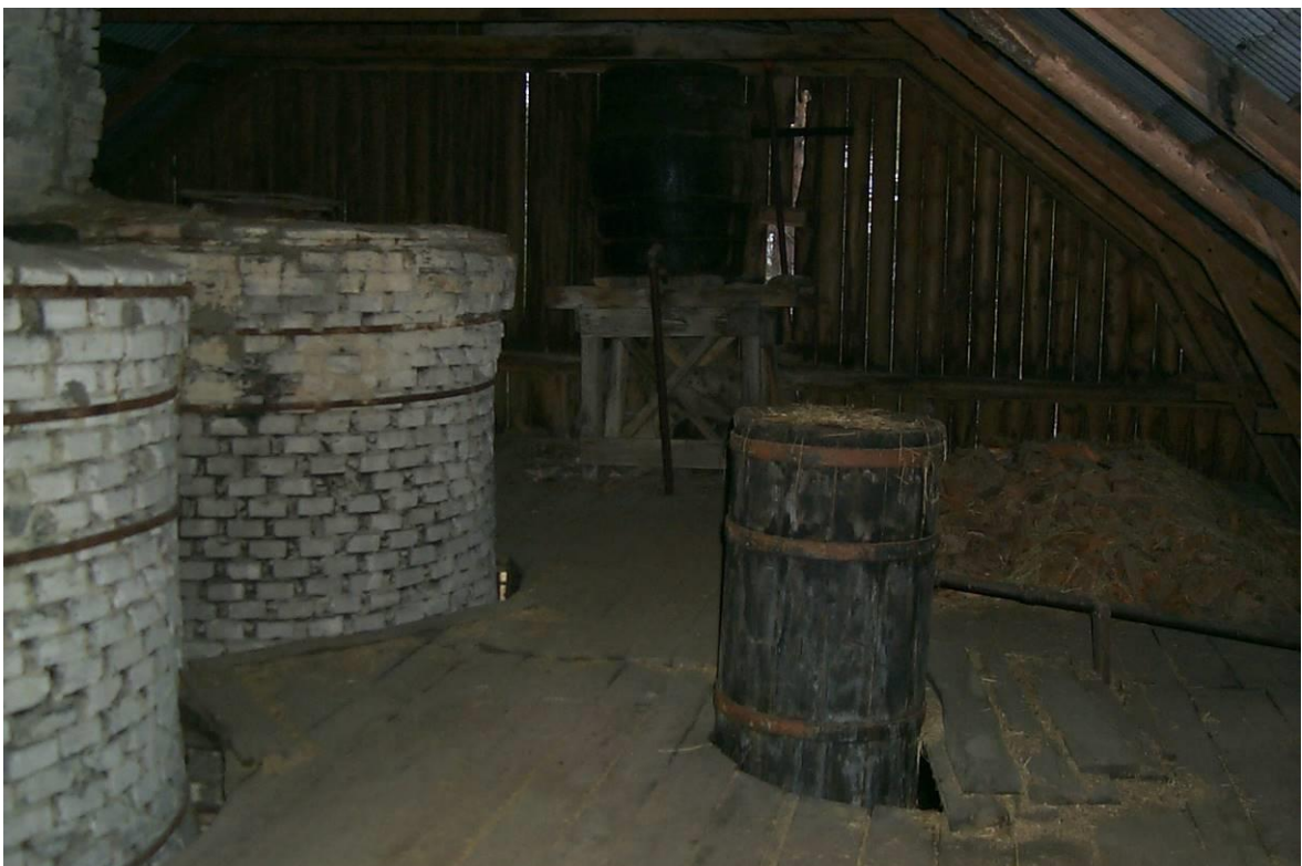
Övervåningen med tjärugnarnas och kylarens övre delar samt i bortkant kylvattentunnan. Rör leder ut ur kylaren på olika höjd, vilket antyder att man hade någon form av fraktionerad destillation.
