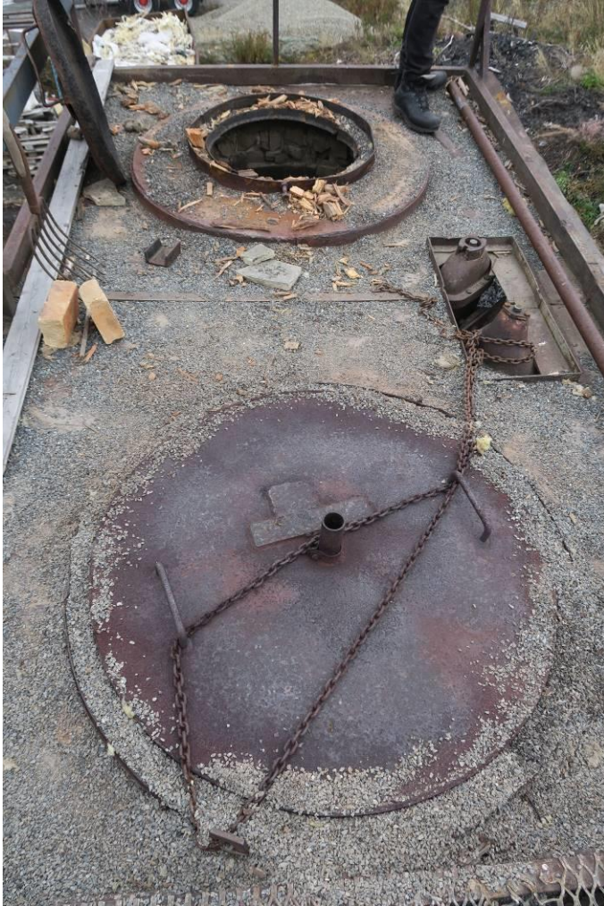
Ugnskonstruktionens överdel. I framkant den tända ugnen och det smala rör som styr tilluften till processen.
