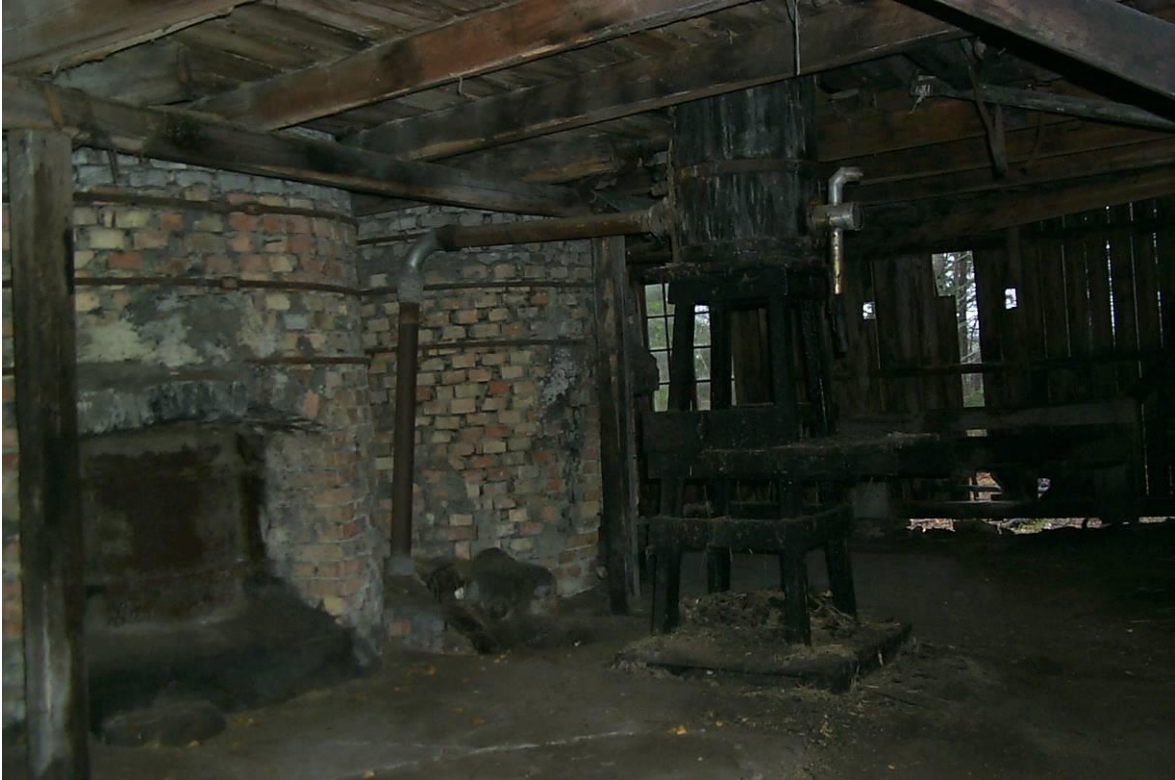
Ugnarna och kylarens nedre del. Till vänster kan man se den nedre manluckan. På den bortre ugnen kan man se avtappningshålet där tjäran rann ut och ned i en hink som stod i hålet. Gaserna samlades ur ett separat hål i ugnens nederdel. Se kylarens röranslutning.
