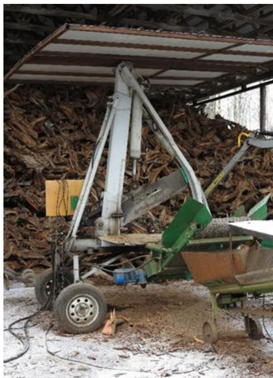
Figur 6: Med den stora hydrauliska kniven skärs stubbarna i småbitar.
