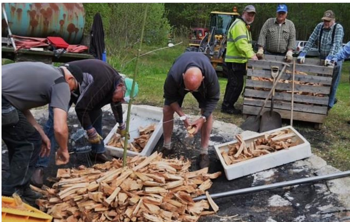
Figur 10: Montage av termoelement. Notera det skyddande järnröret.
