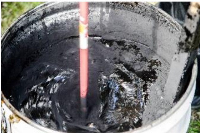
Blandning av kimrök i den förvärmade tjäran, foto Monica Syversen.
