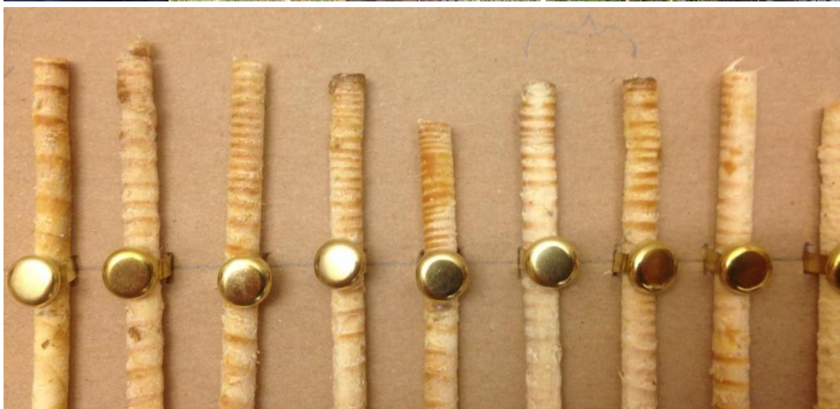
Prövtagning med tillväxtborr i katade tallar och närbild på kärnborsprover. De mörkgula partierna är fetved.
