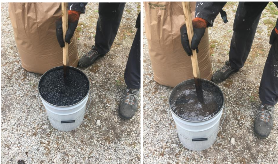
Blandning av tjära i plåthink. När man blandar i kol och kimrök i den varma tjäran så sker en reaktion som får innehållet att skumma och jäsa.
