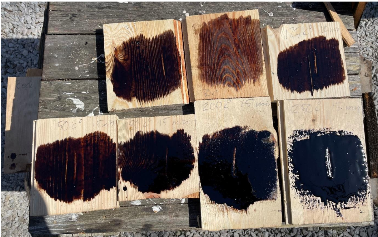
Kokningstest och nedan uppstrykning av tjären vid olika temperaturer på brädor. Med början längst upp till böger är tjären värmd till olika temperaturer med intervallen 30, 50, 125, 150, 180, 200 och 250 grader. Lagda bredvid varandra syns en tydlig förändring av tjärans viskositet.
