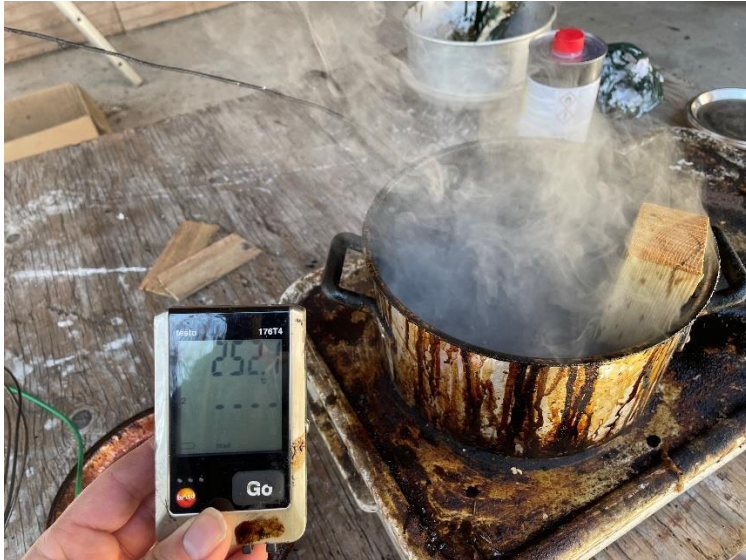
Kokningstest och nedan uppstrykning av tjären vid olika temperaturer på brädor. Med början längst upp till böger är tjären värmd till olika temperaturer med intervallen 30, 50, 125, 150, 180, 200 och 250 grader. Lagda bredvid varandra syns en tydlig förändring av tjärans viskositet.
