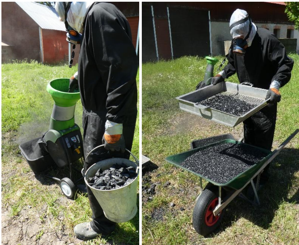
Malning av kol i en kompostkvarn och siktning till rätt kornstorlek i ett 3 mm såll.
