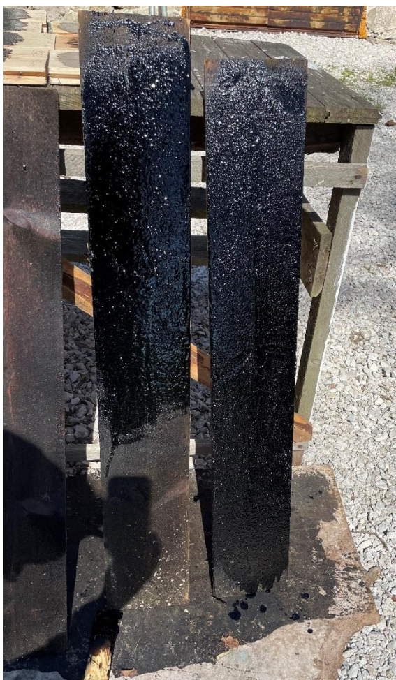
Uppstrykningstest av tjäran på brädor, för att bedöma hur mycket den kommer att röra på sig på en takyta och hur stor avrinningen kommer att bli. Uppstrykningsproven är gjorda när tjäran värmts till 180 grader i 15 min respektive 200 grader i 15 minuter. Bild till höger storkok av tjära.
