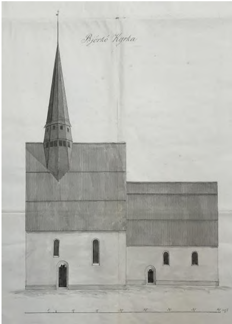
Björke kyrkas sydfasad strax före 1860 års takombyggnad varvid man lät ändra fönstrens form. Märk takryttaren med för Gotland traditionell typ men med ljudgluggar i två våningar. Uppmätning Johan Gustaf Klingwall 1857. Riksarkivet, Ecklesiastikdepartementet, huvudarkivet, kartor och ritningar 12:1.
