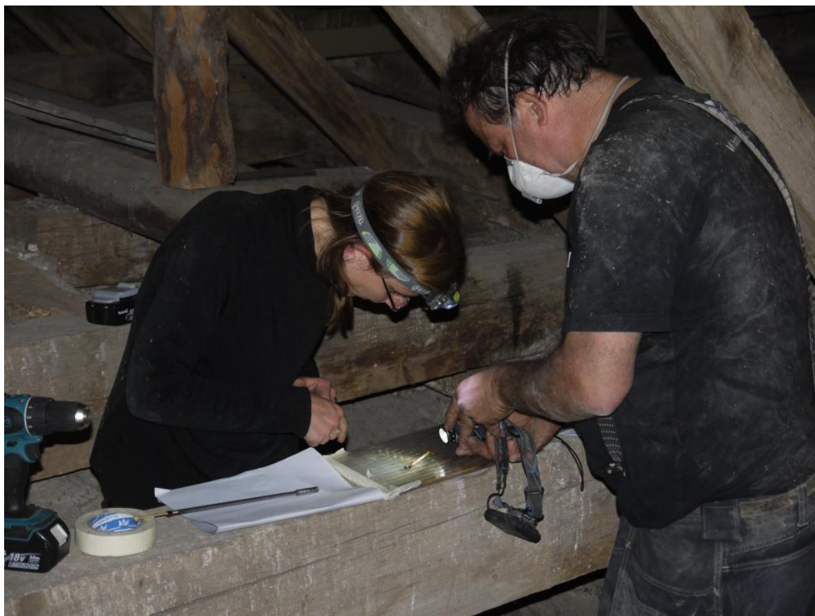
Forshems kyrka långhuset, provtagning för dendrokronologisk datering, Andrea Seim och Jan Michael Stornes, foto K. Linscott 2012
