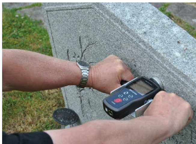
Gravstenen ska stå emot minst 35 kg, från såväl fram- som baksida utan att luta för mycket.
