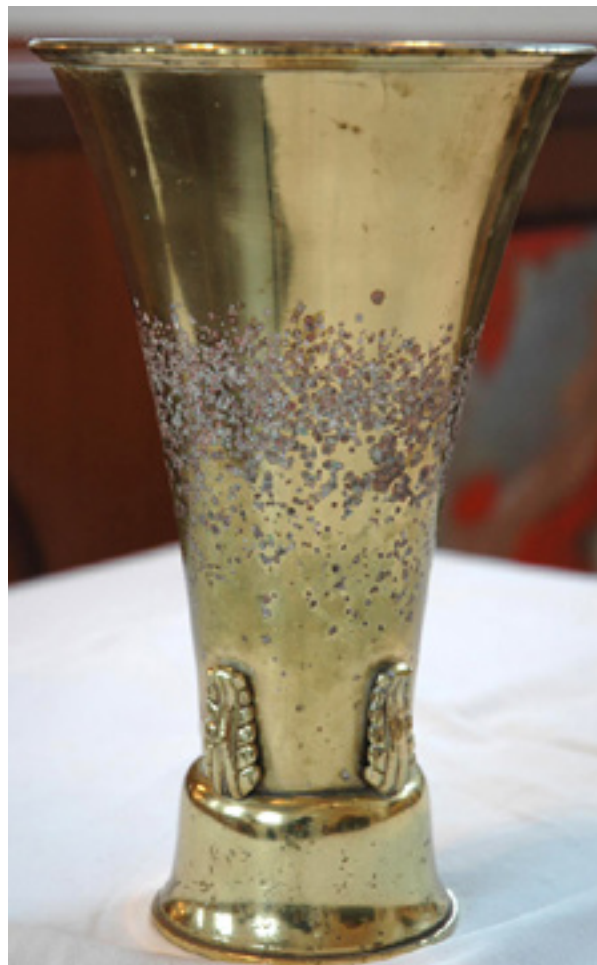
Okunskap om händernas skadliga inverkan har bidragit till vasens allvarliga frätskador i metallytan. Foto: Studio Västsvensk Konservering.
