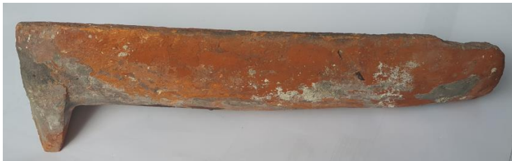
Möjlig medeltida "nunna" ca 44 x 18 cm med avsmalnade slut, återfunnen på tornvinden i Falsterbo kyrka. Denna panna är ca 5 cm längre än de som idag täcker kyrkans tak.
