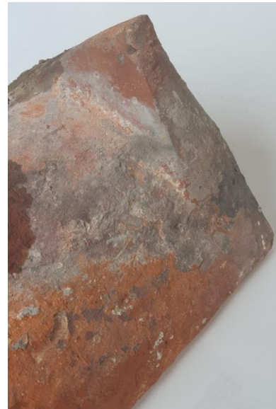
Möjlig medeltida "nunna" ca 44 x 18 cm med avsmalnade slut, återfunnen på tornvinden i Falsterbo kyrka. Denna panna är ca 5 cm längre än de som idag täcker kyrkans tak.
