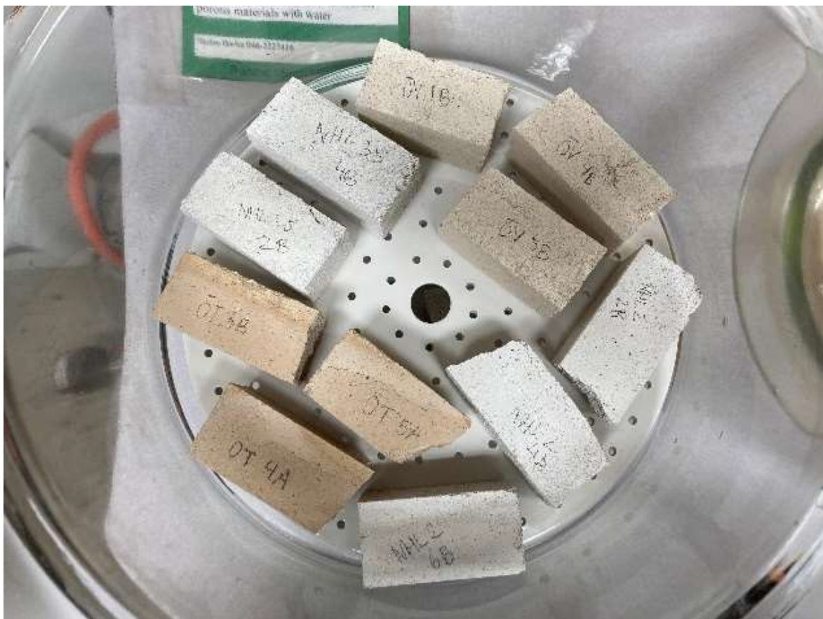
Figur 5.8 Provkroppar placerade i vakuumtorkare inför vakuummätning.
