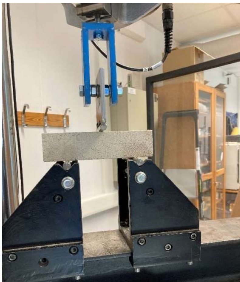
Figur 5.6 Provkropp placerad i MTS-apparat inför böjdraghållfasthetsförsök.
