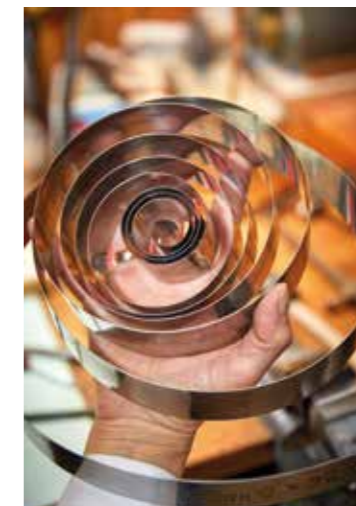
Fjäders driver urverket. Mycket klimateffektiv, går helt utan el och kan fungera i hundratals år.
