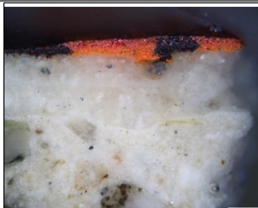
Fig. 47 På mikroskopbild av tvärsnitt syns att pigmenten lokalt oxiderat/mörknat. Möjligheten finns att en skuggningseffekt har sökts och att cinnober inte ligger över hela ytan. Möjligheten finns också att en fördjupning av kulören sökts och att cinnober täckt hela ytan.
