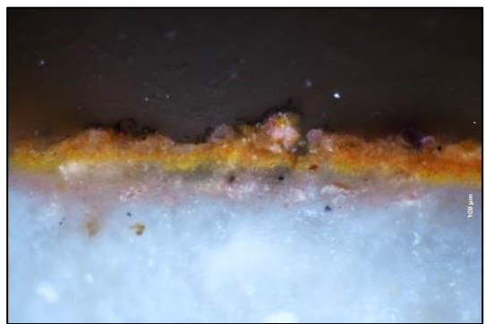
Fig. 32 Mikroskopbild av snitt. Härnevi 24 x 50 DF VIS wet Real Time EDF 2. Skiktföljden tydlig. På en tät, jämn grund ligger först ett blekt, "glost" rödrosa skikt. Därpå ett tydligt gult och överst ett röd, rödorange. Alla skikt väl sammanbundna med varandra. Det undre rödrosa ser, i VIS, ut som att det har färgat grunden. Se även under "skiktmåleri" nedan.
