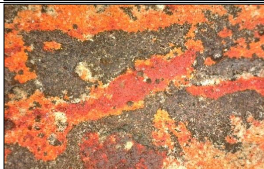
Fig. 45 Rött parti. Överst en tydligt ytligt oxiderad röd där oxidskiktet delvis fallit av. Där verkar finnas ett undre rött skikt av en annan röd. Färgsnitt i området skulle kunna berätta mer om lagerföljden. Det är vanligt att cinnober och blymönja förekommer på samma yta, kanske så även här.
