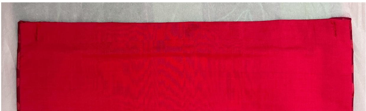
Kanal i form av öppningar i fodret sliter på ovankanten
