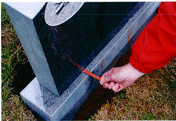
Figur 8. Kontroll av antalet dubbar med bågfilmsblad
