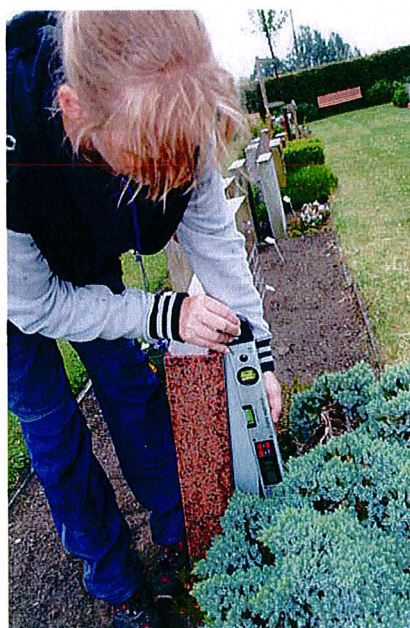
Figur 4. Kontroll av lutning med vinkelindikator.
