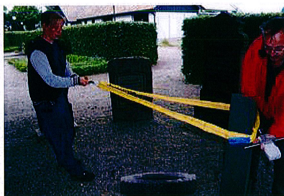
Figur 9. Belastningstest: fjädervåg, lyftstroppslinga och fender, här i form av bildäck.
